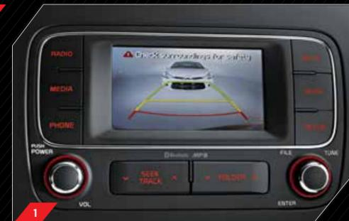
**1. Cámara de visión trasera.** La pantalla táctil de color de 4.3 pulgadas muestra imágenes procedentes de la cámara trasera al poner marcha atrás añadiendo seguridad y comodidad al estacionarse.
