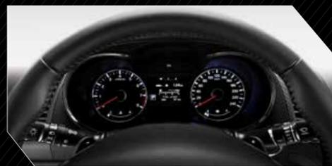
**Supervisión Cluster con pantalla color TFT-LCD de 4.2 pulgadas.** Una amplia gama de información del vehículo disponible en una sola mirada gracias a la interfaz gráfica del usuario ergonómicamente diseñada y acompañada de una luz blanca de alta intensidad.
