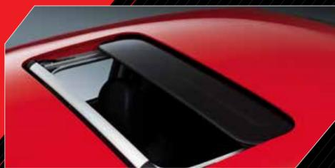
**Sunroof eléctrico de seguridad.** El techo solar eléctrico de seguridad opcional se inclina y se desliza para permitir entrar la luz y el aire a la cabina mientras que el mecanismo de seguridad impide el cierre del vidrio cuando se detecta alguna obstrucción.
