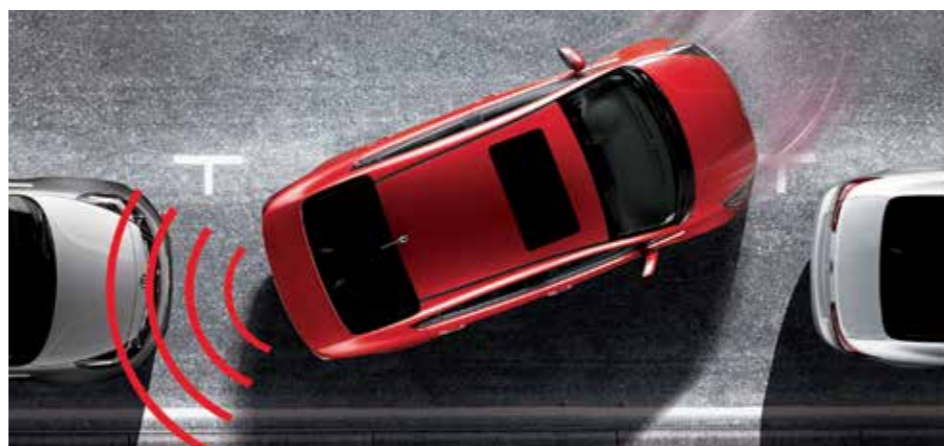
Sensor de retroceso Al dar marcha atrás hacia un espacio de estacionamiento, un sonido de alerta se activa si usted está demasiado cerca de otros vehículos u obstáculos.
